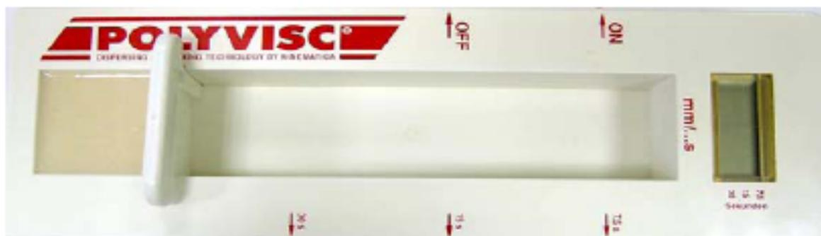
Figure 2.1: Consistomètre de modèle Polyvisc pour la mesure de l'écoulement des produits
